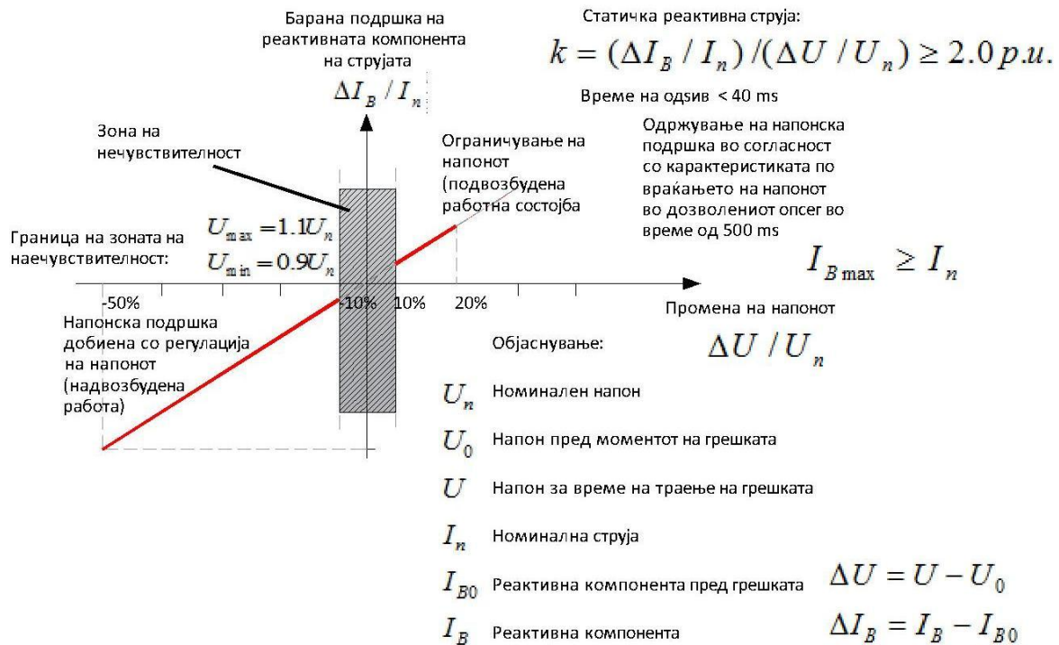
Слика 6 – Принцип за напонска регулација при нормална работа и поддршка на напонот во случај на нарушувања
