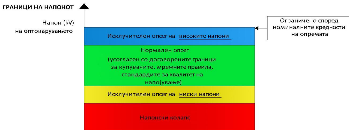
Слика 1 – Принцип за дефинирање на интервалите за напони
